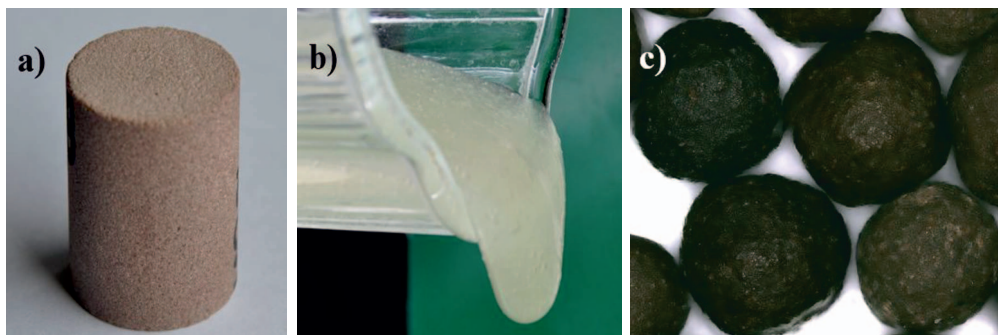
Rys. 6. a) Skała piaskowcowa czerwonego spągowca typu zamkniętego tight gas ; b) sieciowany polymer naturalny 40#; c) podsadzka ceramiczna ISP 20/40
