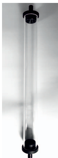
Rys. 6. Widok rury z tworzywa z uszczelnieniami, w którym umocowano dopływ i odpływ cieczy wiertniczej
