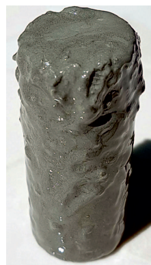
Rys. 11. Zżelowana warstwa płuczki na rdzeniu skalnym po przetłoczeniu standardowej cieczy buforowej
