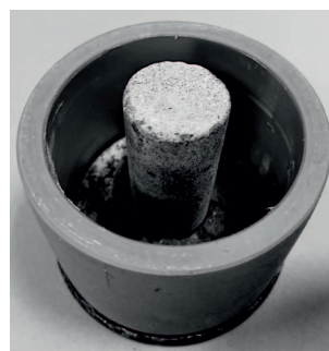
Rys. 7. Próbk rdzenia przygotowana do wypełnienia zaczynem cementowym
