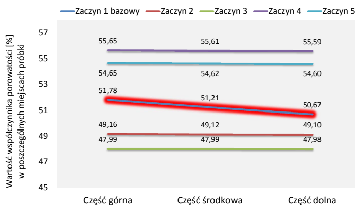
Rys. 6. Zestawienie wartości porowatości stwardniałego zacyzynu w zależności od miejsca poboru próbki (izotropia struktury)
