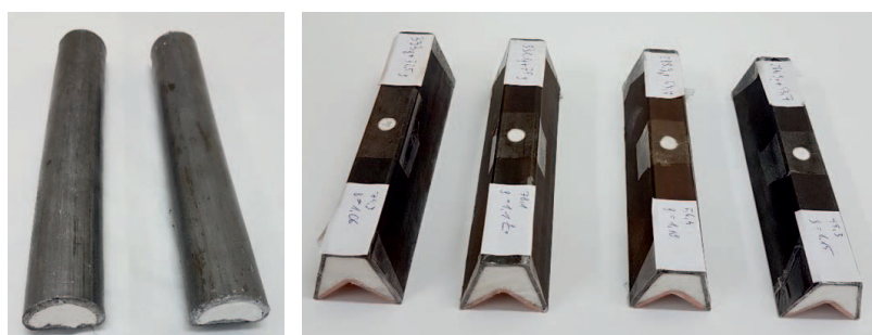
Rys. 6. Widok ładunków kumulacyjnych liniowych przygotowanych do badań sprawnościowych w warunkach poligonu doświadczalnego
