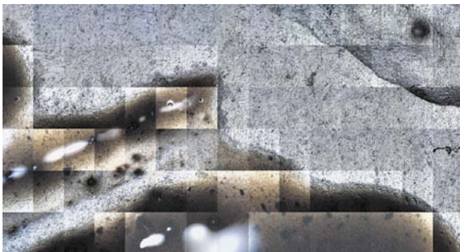
Rys. 3. Zdjęcie mikroskopowe próbki pozostałości wewnątrzbiornikowej (lewy dolny róg) oraz próbki parafiny (prawy górny róg)
